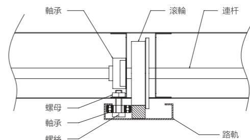
1. 傳動系統集中于移動底架，采用高強度多副組合輪架用M8螺絲緊固，將軸承座緊固在軸承座孔內，在軸承內注入潤滑油後嵌入軸承座內，再進行油封，使軸承內潤滑油長期使用不易風乾，以達到省力作用和移動平穩性。
